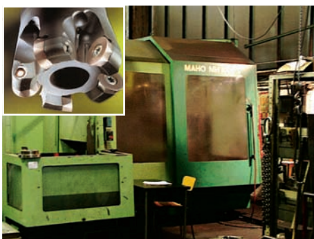
Bild 4: Die eingesetzte Maho 1000 S, eingeklinkt der zur Bearbeitung aus dem Vollen eingesetzte Fräser. Hier hat der schwingungsarme Schnitt den vorher obliquen Getriebewechsel eingespart
