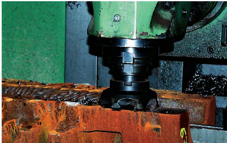
Bild 1: Gewiss keine leichte Aufgabe, das Planen von Referenzflächen mit Schweißnähten durch Avantec-Planfräser, zumal es sich dabei um 42CroMo4 handelt
