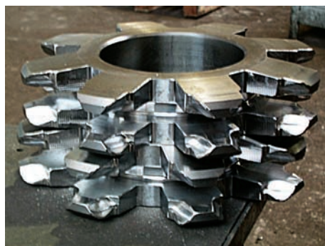
Bild 5: Dieses komplexe Kettenrad mit etwa 800 mm \varnothing ist aus dem Vollen herausgearbeitet. Anders ist das bei den gestiegenen Anforderungen an Präzision und Leistung durch die Kunden nicht mehr möglich
