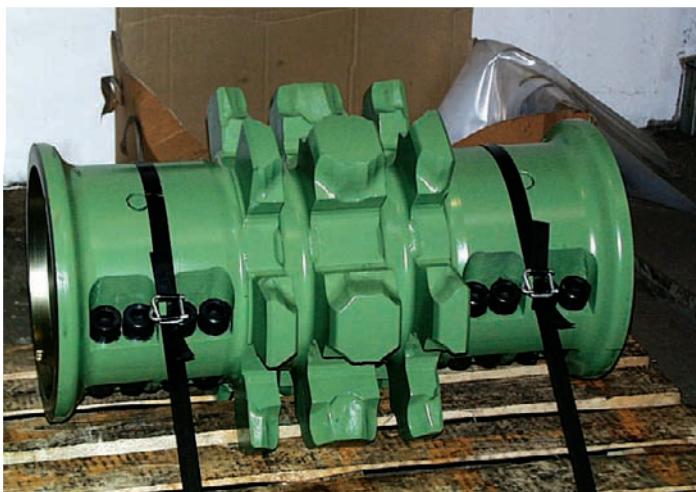
Bild 3: Ein Beispiel für viele ist dieses zweiteilige Kettenrad, das versandfertig auf einer Palette auf seinen Abtransport wartet. Bei Hippenstiel entstehen diese Werkstücke als Einzelteile. 10 Stück bedeuten schon eine Serie
