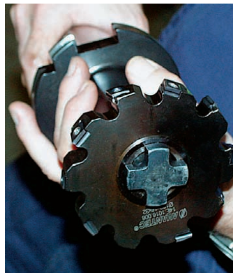
Bild 7: Was so harmlos aussieht, ist geballtes Know-how. Diese Scheibenfräser haben die Fertigung von Klauke auf eine völlig neue Basis gestellt
