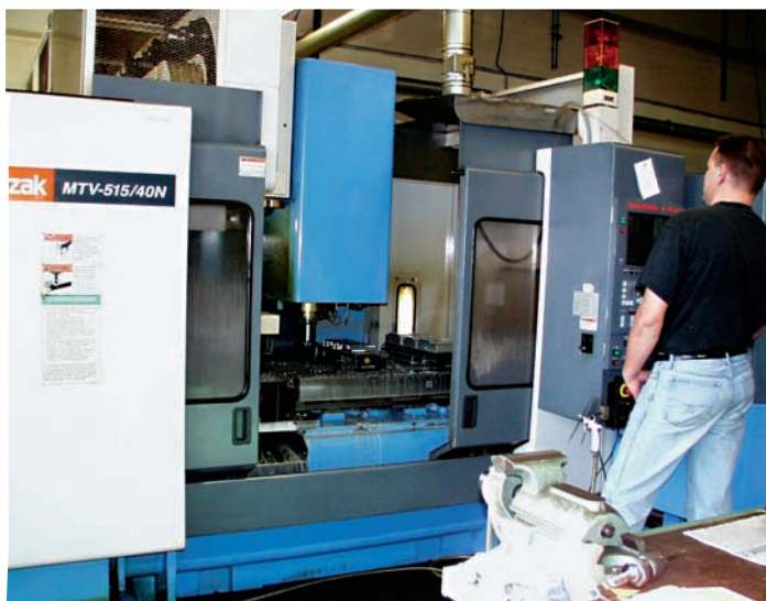
Bild 5: Auch die hochwertigen Maschinen profitieren vom Einsatz der Fräser von Avantec. Nicht nur der weichere und damit schonende Schnitt ist es. Vielmehr wurde die Kapazitätssituation durch die Verdreifachung der Spanmenge pro Zeiteinheit spürbar verbessert
