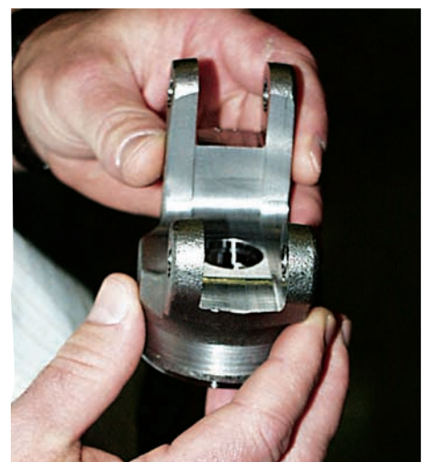
Bild 3: Eines dieser Teile aus 42CroMo4V, die so harmlos aussehen. Doch deren Bearbeitung hat's in sich. Allein schon die erzielten Flächen gehörten vor der Avantec-Aera nicht zum Standard
