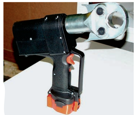
Bild 2: Mit diesen akkuhydraulischen Zangen lassen sich lineare Drücke bis zu 12 Tonnen aufbringen. Ein ideales Werkzeug zur lötfreien Herstellung von Rohrverbindungen
