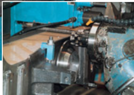
Der modular aufgebaute MULTIRING EM90 ist bei dieser Bearbeitung aus drei Ring-Segmenten zusammengesetzt. Sowohl die Zerspanung mit KSS als auch die Trockenbearbeitung ist möglich.
