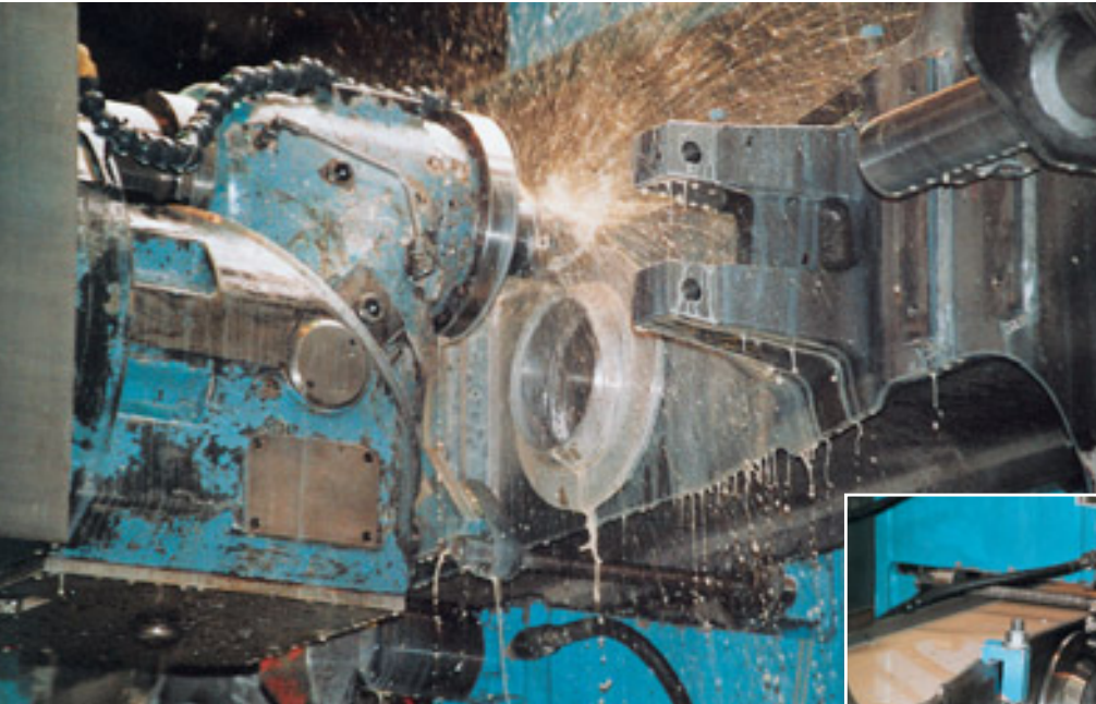
Der modular aufgebaute MULTIRING EM90 ist bei dieser Bearbeitung aus drei Ring-Segmenten zusammengesetzt. Sowohl die Zerspanung mit KSS als auch die Trockenbearbeitung ist möglich.
