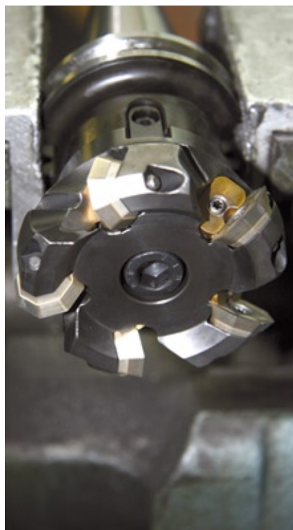
Gut zu erkennen: Die Doppelklemmung bei dem 45° Fräser.
