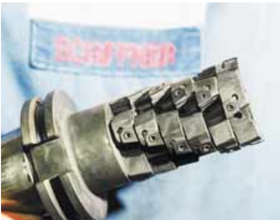
Der modulare Multiring-„Avantec-Igel“ mit hochpositivem Schneidwinkel und Links/rechts-Stellung der Schneidplatten zu Kompensation der axialen Kräfte. Weichschneidend, vibrationsdämpfend, maschinen- und geldbeutelstschonend.
