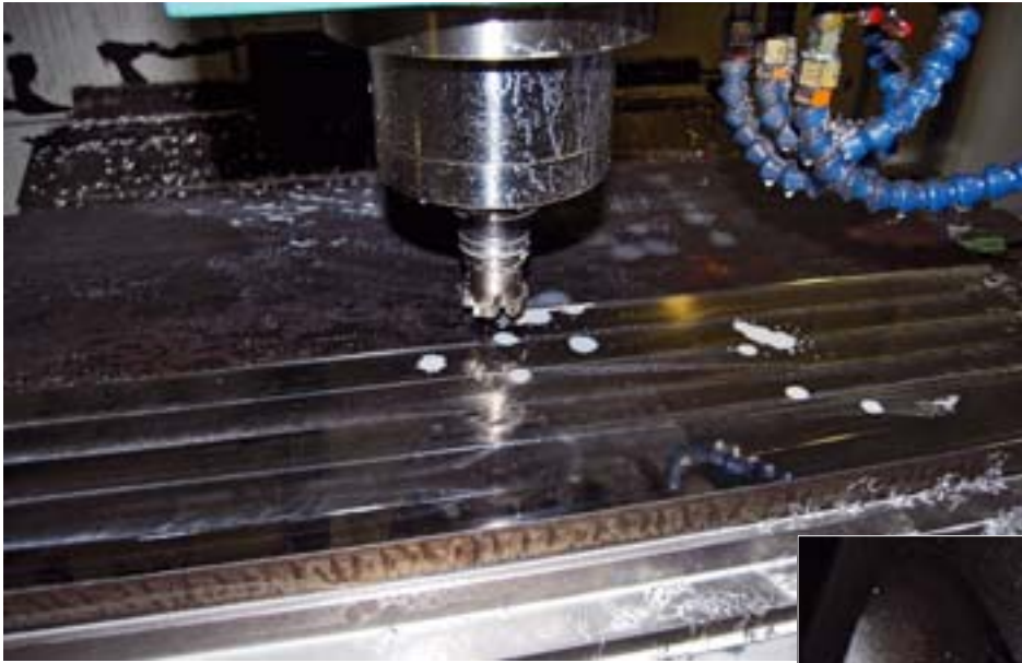
Die Wärmedichtplatten sehen unscheinbar aus, haben es aber in sich: Der auf 900 N/mm 2 vergütete C45-Werkstoff ist ausschließlich mittels Magnetplatte geklemmt. Mit den Avantec-Fräsern wird im ersten Schnitt eine Oberflächenqualität von Rz=0,6 erreicht (oben)
