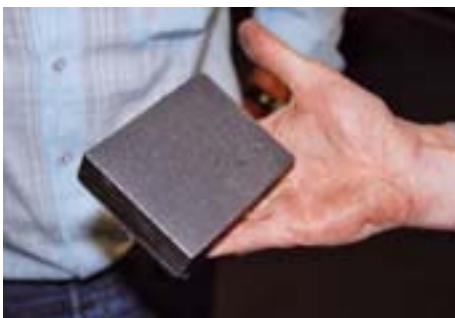
Eine weitere Rebi-Spezialität sind Bauteile, die aus diesem extrem verschleißfesten, Hardox genannten Werkstoff für die Bahntechnik gefertigt werden. Hier kamen die Bearbeitungszentren der Solinger in der Vergangenheit oft an die Grenze ihrer Leistungsfähigkeit
