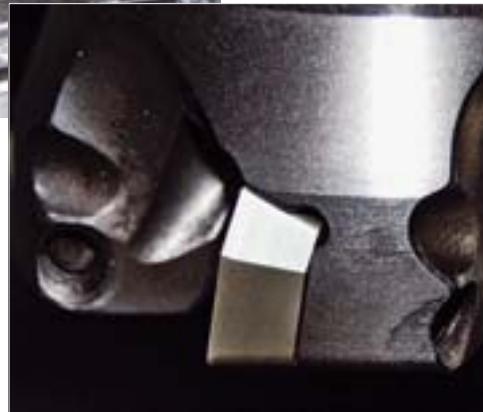
Die Wärmedichtplatten sehen unscheinbar aus, haben es aber in sich: Der auf 900 N/mm 2 vergütete C45-Werkstoff ist ausschließlich mittels Magnetplatte geklemmt. Mit den Avantec-Fräsern wird im ersten Schnitt eine Oberflächenqualität von Rz=0,6 erreicht (oben)
