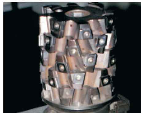
Bild 2: Die Walzenstirnfräser – allgemein als Igelfräser bezeichnet – aus der Multiring-Serie sind ebenfalls erfolgreich im Einsatz
