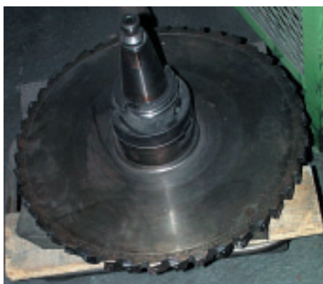
Bild 4: Beachtliche Durchmesser erreichen die Scheibenfräser. Da müssen sie speziell bei großen Spindelaustragungen sehr vibrationsarm arbeiten können
