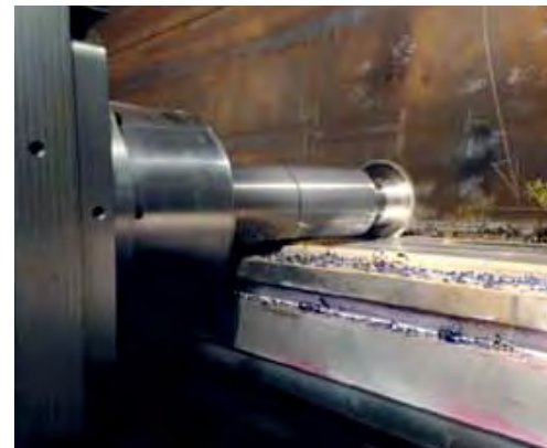
Lavorazione cava nella sede della piastra eseguita con una fresa a disco della Avantec
