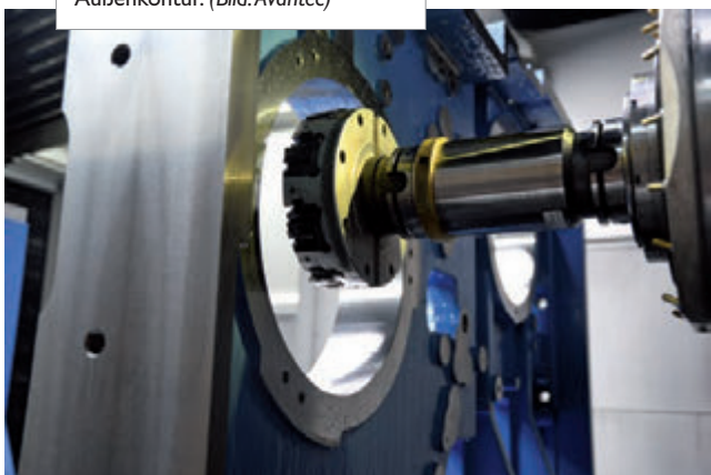
Der Finavant EK90 mit Durchmesser 100 mm und sechs Zähnen beim Schlichten der Außenkontur. (Bild:Avantec)
