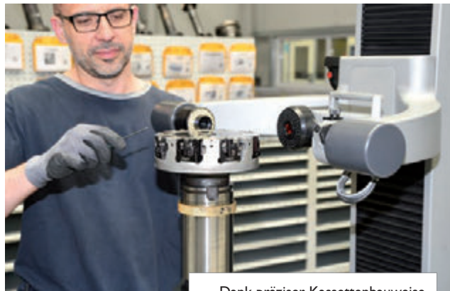
Dank präziser Kassettenbauweise und einfacher Feineinstellung können die Mitarbeiter die EK90-Fräser bis auf null einstellen. (Bild:Avantec)
