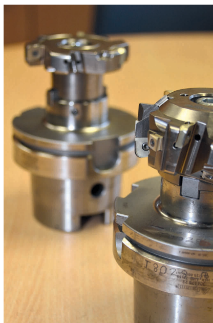
4 Jeder Xtra Kontur trägt wie hier rechts in der 80-mm-Version zwölf verschiedene Wendeschneidplatten. Hinten der Schlicht-Scheibenfräser Xtra MT 90 (© Hanser)
