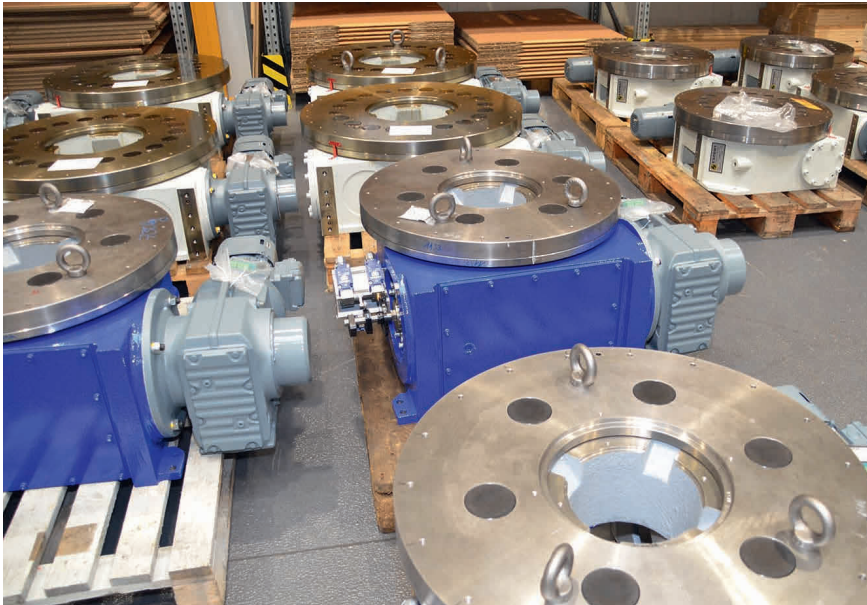
2 Solche Drehtische für den Automobilbau sind das Kernprodukt in Lorsch. Es gibt sie standardmäßig in 16 Varianten von 350 bis 3200 mm Durchmesser [© Hanser]
