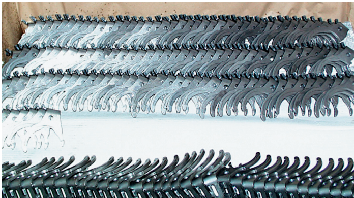
Bild 3: Fertigungssicherheit konnte erst mit dem Einsatz von Avantec-Werkzeugen erzielt werden. Die teureren Werkzeuge haben sich für die großen Serien allein schon durch die höhere Standzeit und die fehlende Nacharbeit mehr als bezahlt gemacht
