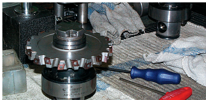
Bild 5: Sehr weicher Schnitt, keine Vibrationen: Spezielle Fräserkörper mit ebenso speziellen Schneidplatten vom Spezialisten haben die anstehenden Probleme gelöst. Und wer es genau wissen will: Der Fräser heißt EN18 in der Größe 125
